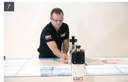
7 Doble el revestimiento debajo del rodillo.
