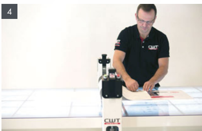
4 Tire de la mitad de material adhesivo sobre el rodillo.
