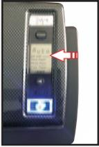
Al prender el equipo se muestra una configuración predeterminada marcada con la leyenda **AUTO**, dichos valores no pueden ser manipulados ya que se encuentra en proceso de calentamiento. Con los parámetros iniciales (**AUTO**) se puede realizar el proceso de enmicado. **Nota: La configuración inicial del equipo podrá ser manipulada una vez que se prenda el botón en color verde con la palabra READY.**
